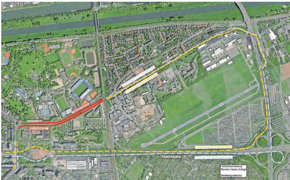
Die sanierungsbedürftigen Straßenabschnitte (rot markiert) werden teilweise im Deckenbereich und teilweise vollständig erneuert. Die Umleitungsstrecken sind mit gestrichelten Linien markiert. FOTO: STADT MANNHEIM
