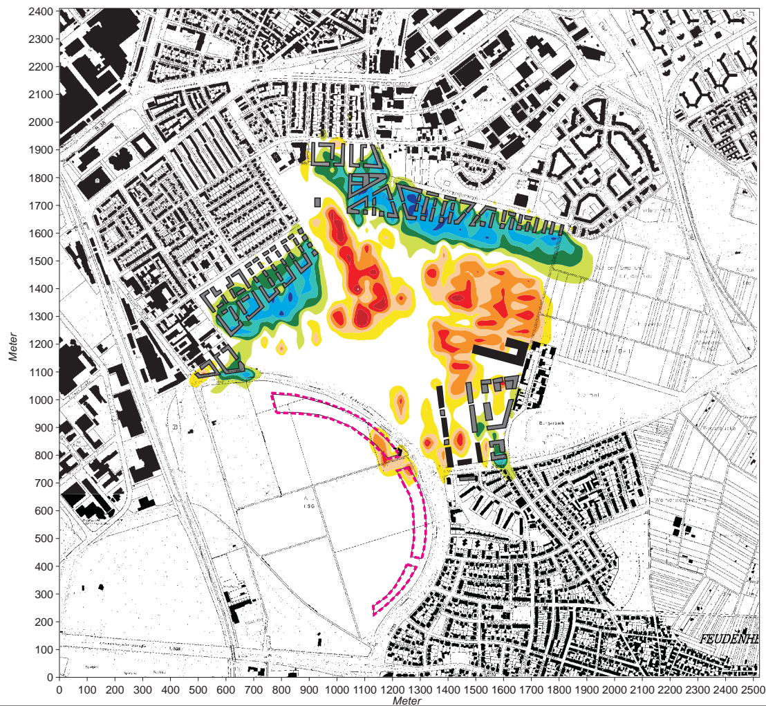
Abb. 29.1 Veränderung der Belüftungsverhältnisse 2 m ü.G. durch den Plan-Zustand gegenüber dem Ist-Zustand, Windanströmung aus Nordnordwesten mit 2.0 m/s in einer Höhe von 10 m ü.G.
