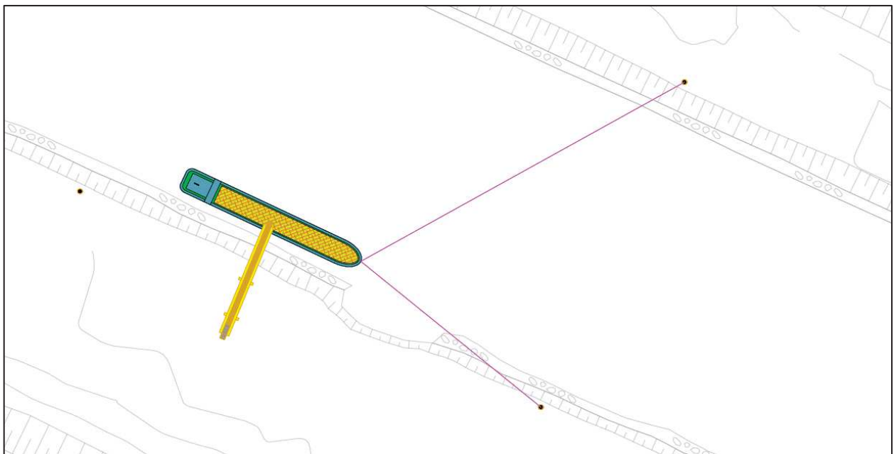
Abbildung 40: Skizze zum Festmachen der Schiffe für den Abtransport des Aushubs
